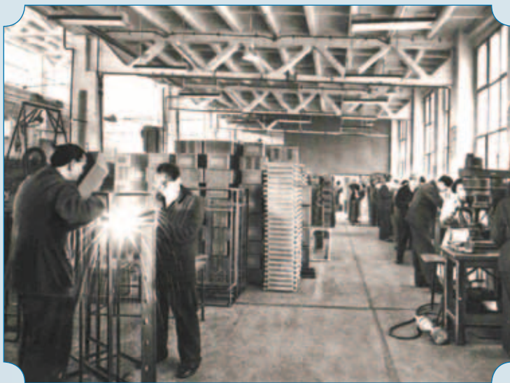
Опытный завод им. Коминтерна. Изготовление кожухов аппаратуры. 1970-е годы
