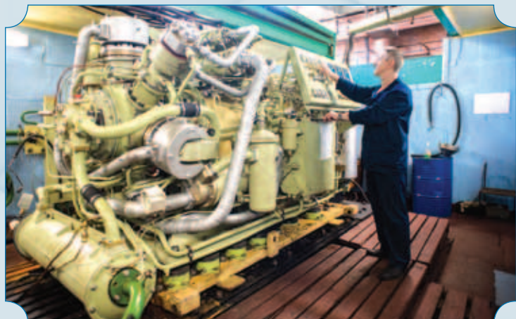
Компрессор высокого давления на испытательном стенде
