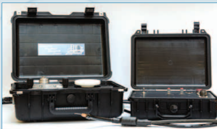
Аппарат для подводной сварки КОПС-М
