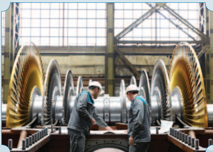
Ротор низкого давления паровой турбины для АЭС
