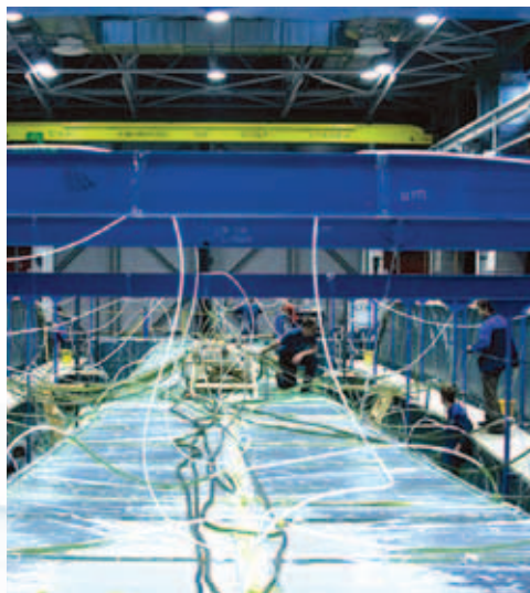
Формирование корпуса пассажирского катамарана методом вакуумной инфузии
