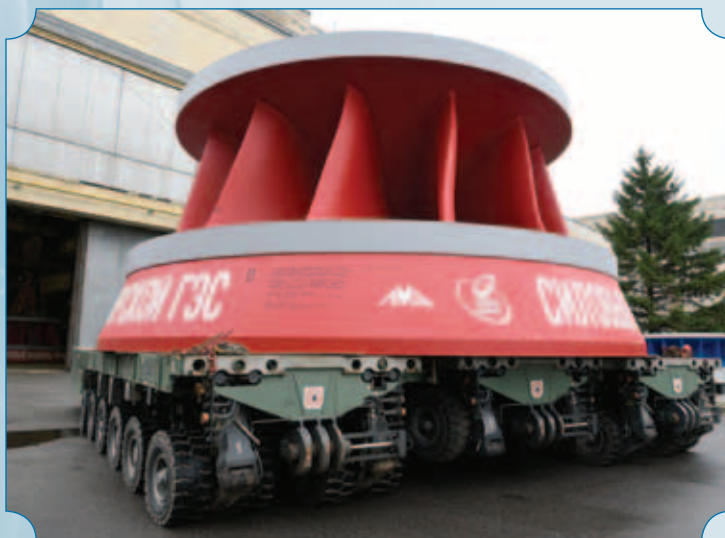
Отгрузка рабочего колеса гидротурбины для Красноярской ГЭС
