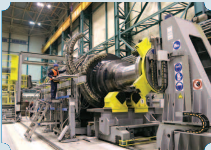
Горизонтальный стэнд автоматической сварки роторов
