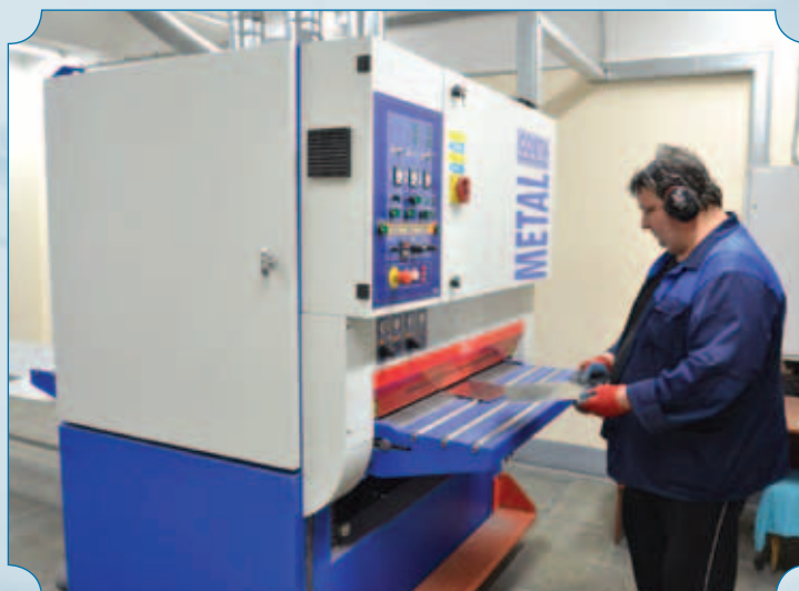
Автоматизированная установка по снятию заусенцев и притуплению острых кромок на листовых деталях
