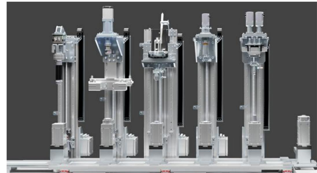
Автоматическая линия сборки полуфабриката привода
