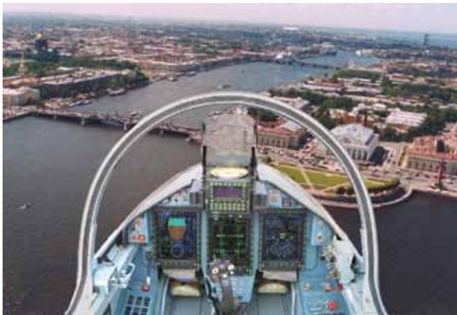
Ярким примером реализации возможностей ОКБ является разработанный на предприятии комплекс К-130.01Э для самолета Як-130. Комплекс включает широкий спектр аппаратуры, разработанной ОКБ «Электроавтоматика»: двухконтурную вычислительную машину, индикаторы на жидкокристаллических панелях, коллиматорный авиационный индикатор, многофункциональные пульты управления, систему формирования картографической информации, наשלнную систему целеуказания.
