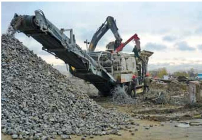
ГК «КрашМаш» при выполнении работ по демонтажу применяет «экскаваторы-разрушители» с вылетом стрелы от 9 до 40 метров, оборудованные гидравлическими ножницами, и мобильные дробильные комплексы для последующей переработки материалов, полученных в результате демонтажа. Материалы дробятся во вторичный щебень и кирпичную крошку и используются при работах нулевого цикла в дальнейшем строительстве.
