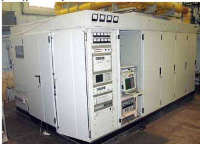
ОАО «РИМР» продолжает традиции мощного радиостроения. Современный радиопередатчик для дальней связи и цифрового радиовещания «Серенада» мощностью 100 кВт предназначен для организации вещания, в том числе и по стандарту DRM, а также для магистральной радиосвязи с возможностью передачи цифровой информации на расстояние более 10 тыс. км.
