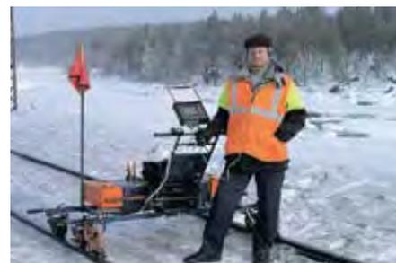
**Двухниточный ультразвуковой дефектоскоп АВИКОН-11**
