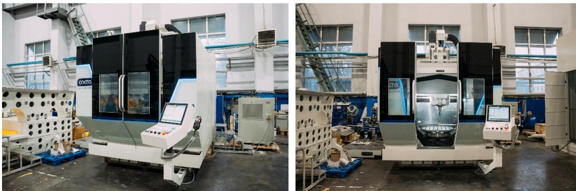
**MC800-5X** - это современный высокотехнологичный станок, разработанный для выполнения сложных задач в области обработки металлов, композитов и других материалов. Идеально подходит для обработки сложных корпусных деталей за один установ.
